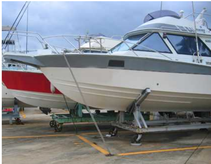
写真－3.5 係船環とロープによる固定例
