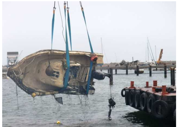
マリーナ水域内に沈んだ ボートの引き揚げ作業
